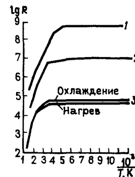
Рис. 168. Графики температурных зависимостей сопротивления образцов, легированных мышьяком в присутствии в шихте Ti и In: Массовое содержание As, %: 1 — 0,01; 2 — 0,14; 3 — 1,0
